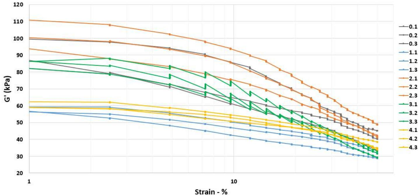
Barido de deformación: desde 0,1% hasta 50% // @ frecuencia 1 Hz // temperatura 29°C
