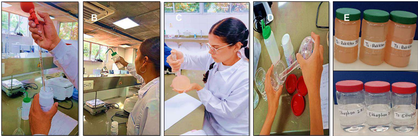
A. Extracción del producto B. Vertimiento de agua destilada al balón aforado C. Homogenización D. Empacado E. Rotulado.
