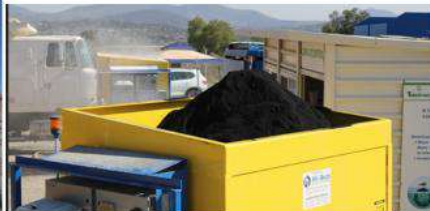
TOLVAS CON SISTEMA NEUMATICO PARA EL POLVO DE NFU ACTIVADO
