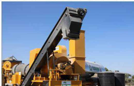
TOLVAS CON SISTEMA NEUMATICO PARA EL POLVO DE NFU ACTIVADO
